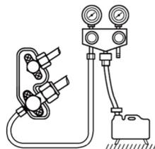
Полностью откройте клапана трубопроводов хладагента наружного блока, сначала жидкостного, а затем газового.
